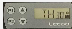
送信/受信LCD表示 送信/受信はLCD表示とLDEが点灯します。
